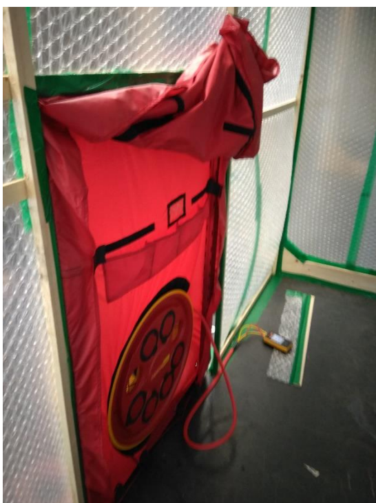
Figuur 4: Meetdeur met ventilator (onderdruk)
